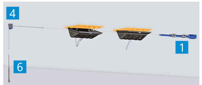
Zentrale Steuerung von Deckenventilen ZED (s.s.) mit einem Elektrozyylinder
