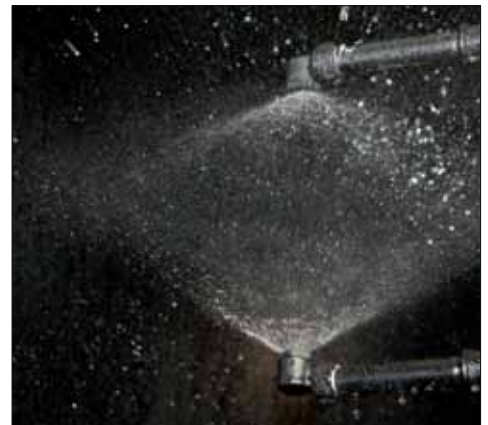
Düsenanordnung für optimale Staub- und NH 3 -Bindung / Nozzle configuration for optimum dust and NH 3 bonding
